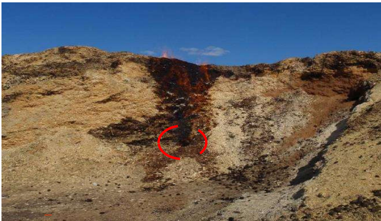
Kuva 7. Aumapalon syttymälähde noin klo 16.20 palokunnan tullessa. Pyöräkuormaaja oli ottanut alueelta tavaraa klo 13.00.
