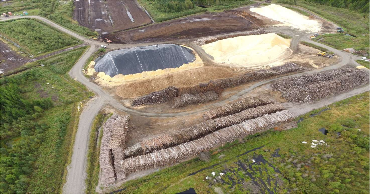
Kuva 1. Energiapuutermiinaali, jossa on myös pieni turveauma. Alue on noin kahden hehtaarin kokoinen. Kuva: Kuopion Energia
