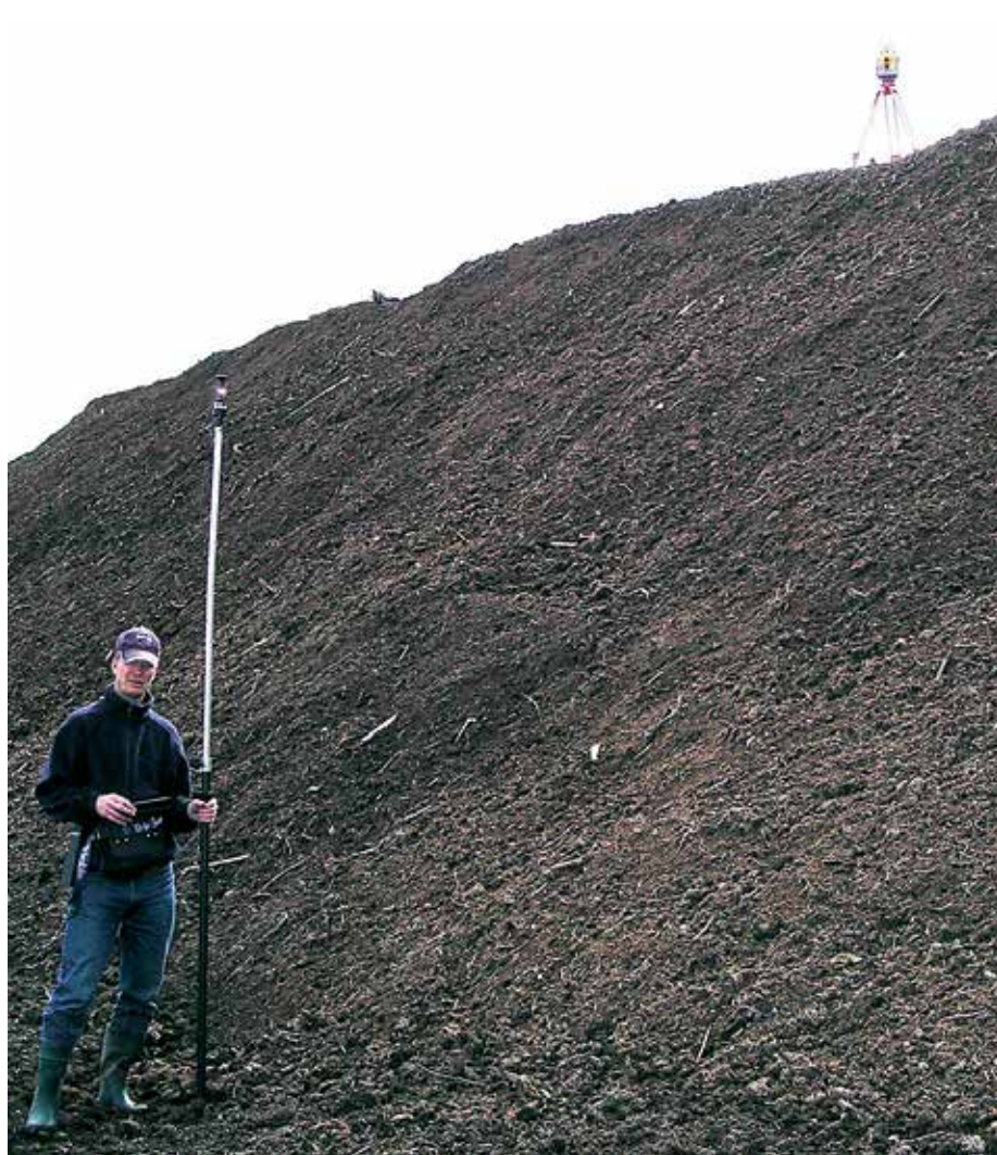
Robottitakymetriin perustuva mittaus. Mittaaja seisoo auman ja maanpinnan yhtymäkohdassa, joka on määritettävä tarkasti oikeaan mittaustulokseen pääsemiseksi. Kuva: ProAgria Etelä-Pohjanmaa.
