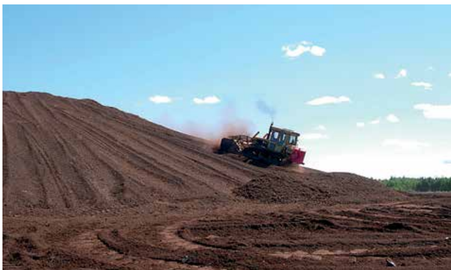
Puskuaumaus on yleisintä Pohjois-Suomessa. Aumauksessa käytetyllä puskutraktorilla tai rinnekoneesta muunnetulla erikoiskoneella muodostuu pyramidin tai kartion muotoinen tai pitkänomainen turveauma. Kuva: Vapo Oy.
