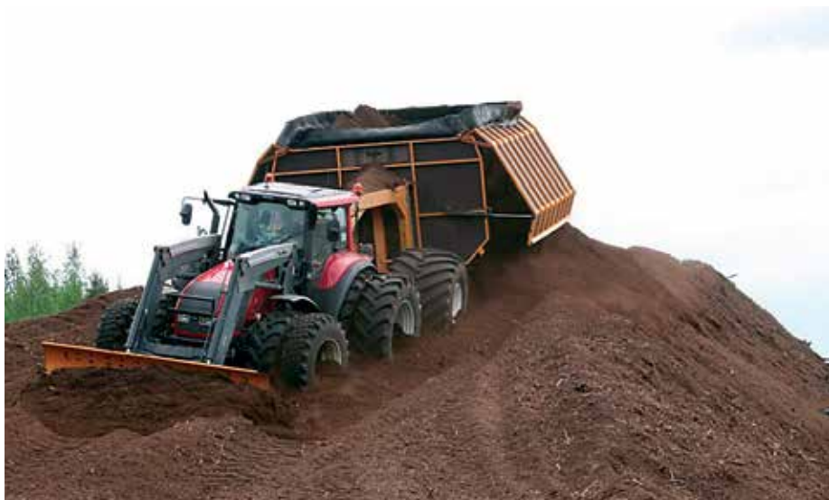
Päälleajoaumaus on yleinen aumaustapa Etelä- ja Keski-Suomessa. Kuva: Bioenergia ry.
